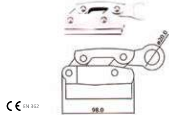
CE EN 362 LX09 Rope Grab / 20MM EYE Stamping Steel 16MM Nylon Rope
