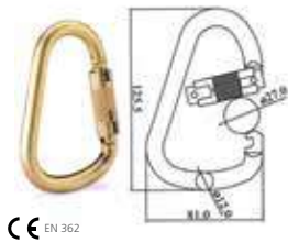
CE EN 362 LX07 Carabiner / Twist Lock Alloy Steel MBL: 35kn
